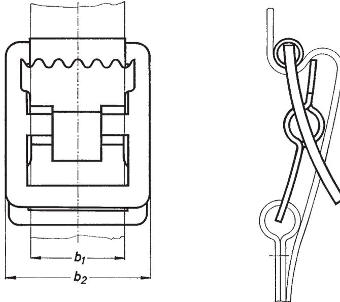
Bezeichnung einer Klemmschnalle für Gurtbreite  $b_1 = 25$  mm aus Stahl (St), Ausführung vernickelt:
